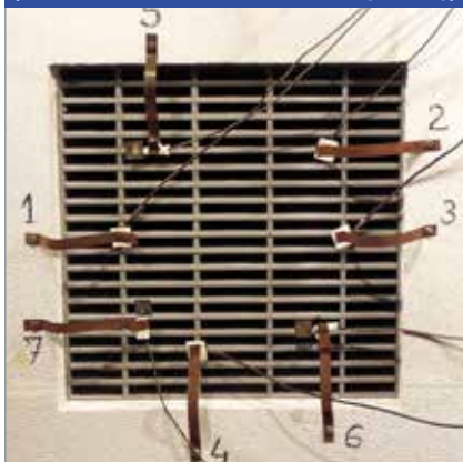
VENTILODICE V przed rozpoczęciem testów (strona nie narażona na działanie temperatury)
