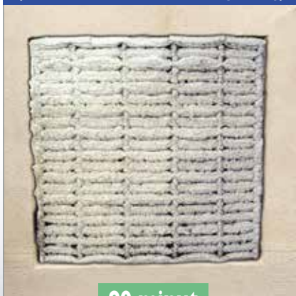
VENTILODICE V 90 minut od rozpoczęcia testu (strona narażona na działanie temperatury)
